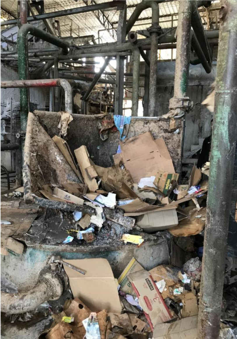
Figura 9. Pulper cargado con insumos y cartón para fabricar papel kraft. Fotografía propia.
